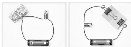
認識電路的通路、斷路意義，知道正確的連接電池、電線、燈泡和小馬達。
